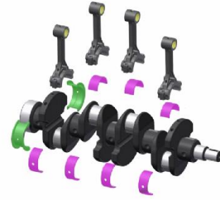
ذراع التوصيل : connecting rod
