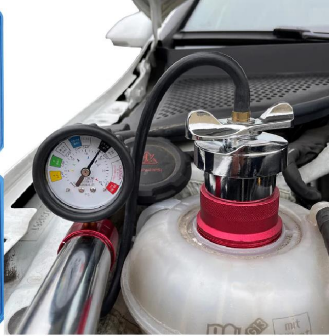
ربط جهاز فحص التسريب
