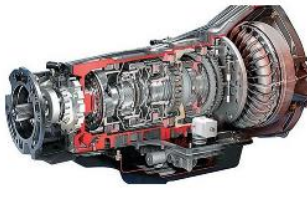
علبة السرعات الأوتوماتيكية الهيدروليكية
