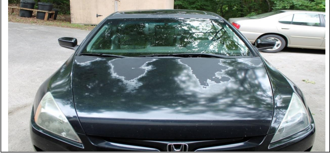
الشكل (10) تأثير جسم المركبة من المطر الحمضي
