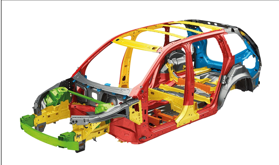
الشكل (2) الأجزاء الرئيسية الداخلية الثابتة لجسم المركبة
