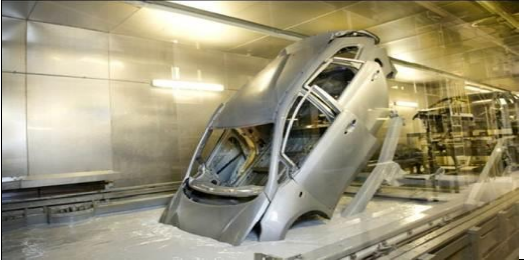
الشكل (3) عملية الجلفنة للمركبات
