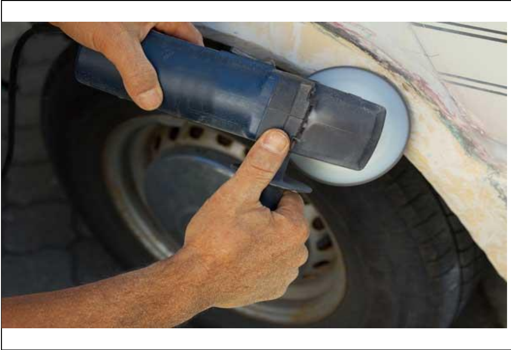
الشكل (12) قطع طرف الجناح المكسور
