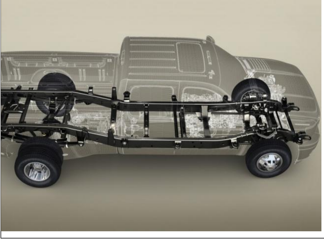
الشكل (2) هيكل المنفصل في المركبات المتوسطة الحمولة .
