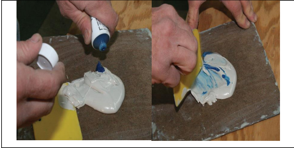
الشكل(8) عملية خلط المعجونة .
