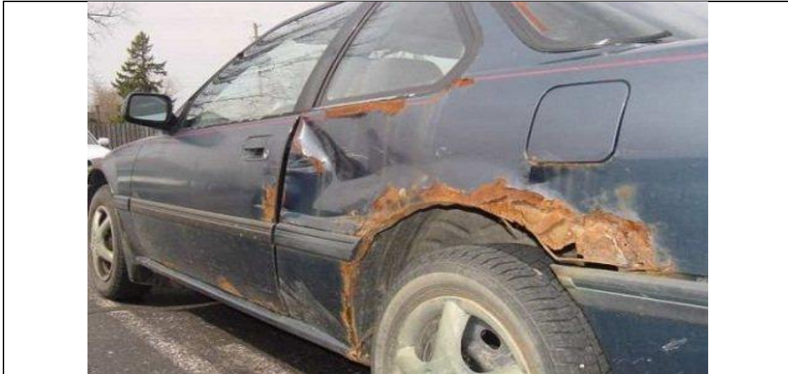
الشكل (1)الصداء في جسم المركبة
