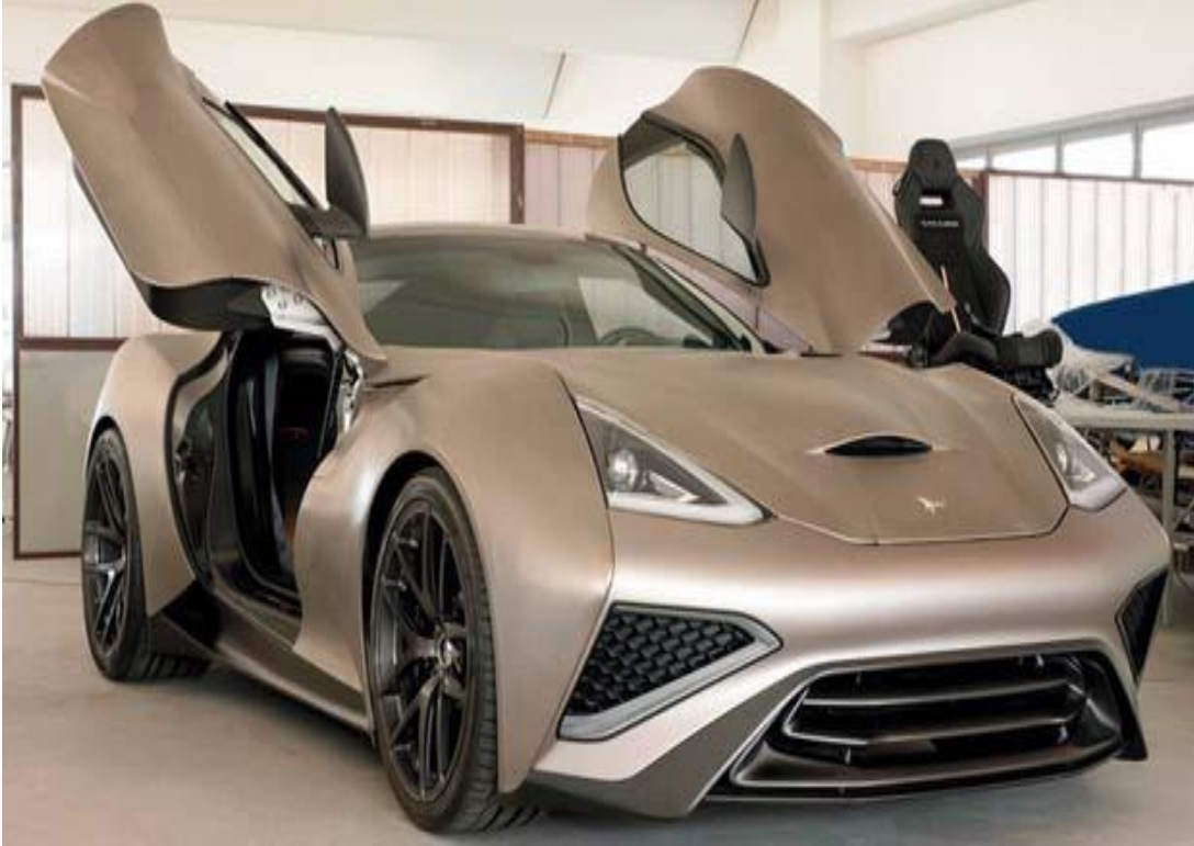
الشكل (8) جسم مركبة مصنوع بالكامل من اللداين
