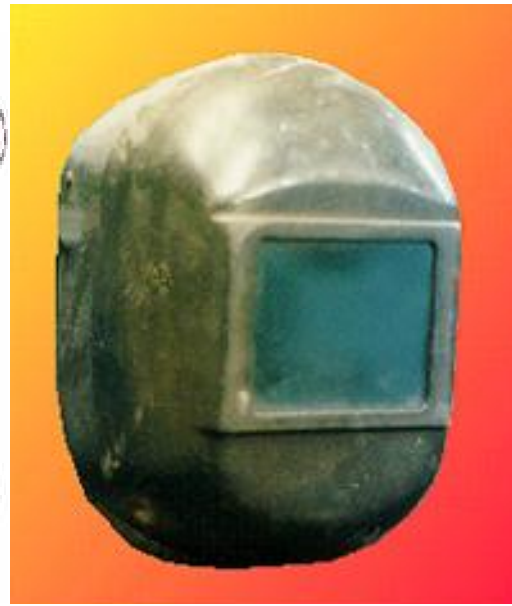
الخوذة الواقية لأعمال اللحام
