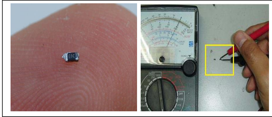
شكل (38): مقاومة مسطحة وكيفية فحصها
