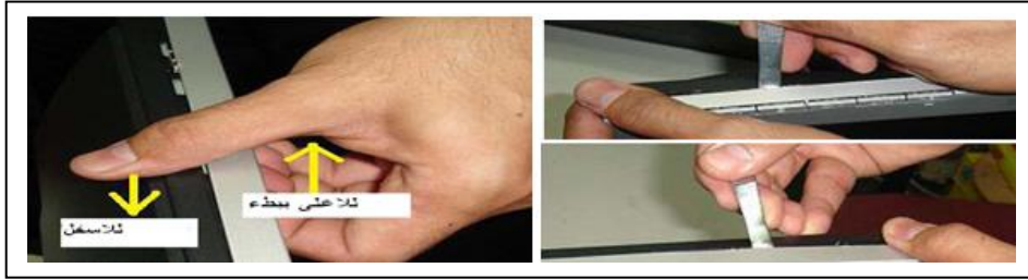
شكل (18): إزالة الإطار الخارجي للشاشة
