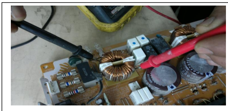
شكل (25): طريقة فحص الملف
