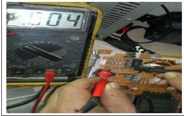
شكل (22): طريقة فحص الفيوزات
