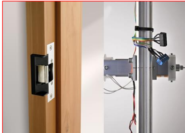
شكل (29): مجمع قفل كهربائي في نظام انتركم الاختبار الأدائي للتمرين العملي رقم (8)
