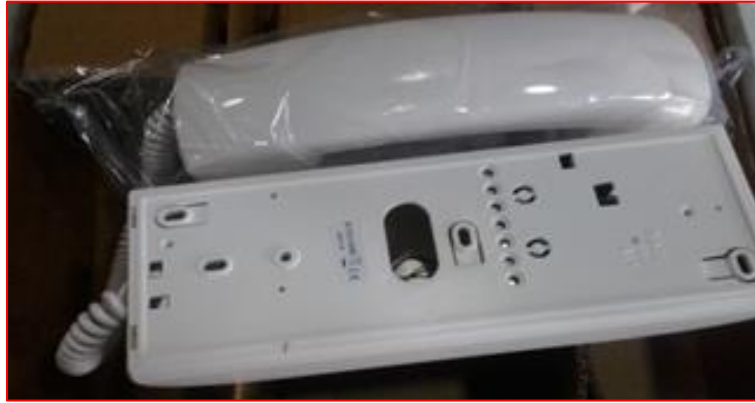
شكل (7): واجهة خلفية لسماعة انتركم تحتوي أماكن توصيل أسلاك النظام
