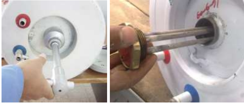
شكل (7-8) فك قلب السخان باستخدام مفتاح حبة كبس قياس 55 ملم واسحبة للخارج
