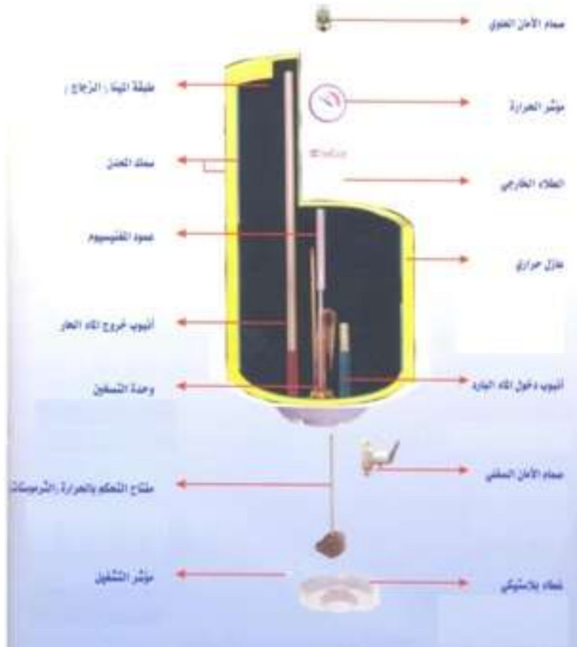
شكل (3-8) اجزاء السخان الكهربائي
