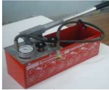
شكل (4-21) ماكينة فحص التسريبات
