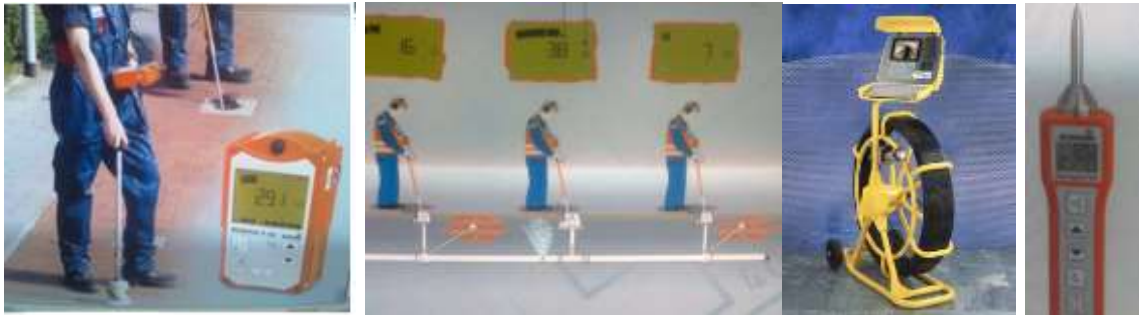
شكل (4-22) اجهزة كشف التسريبات
