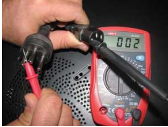
شكل (2) فحص اطراف الكابل
