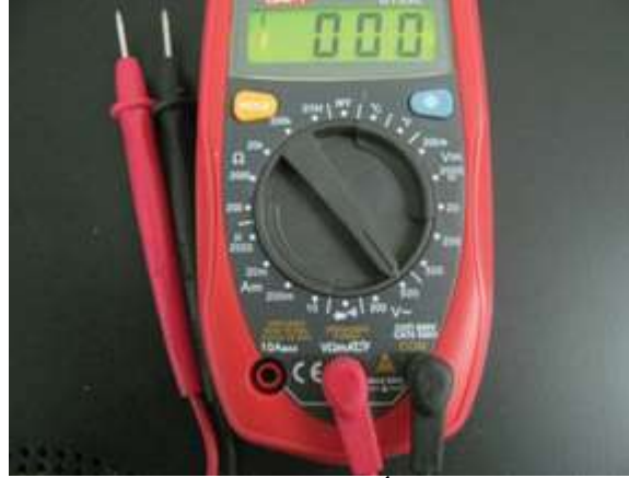
شكل ( 3 ) جهاز الأفوميتر في وضعية قياس الجهد
