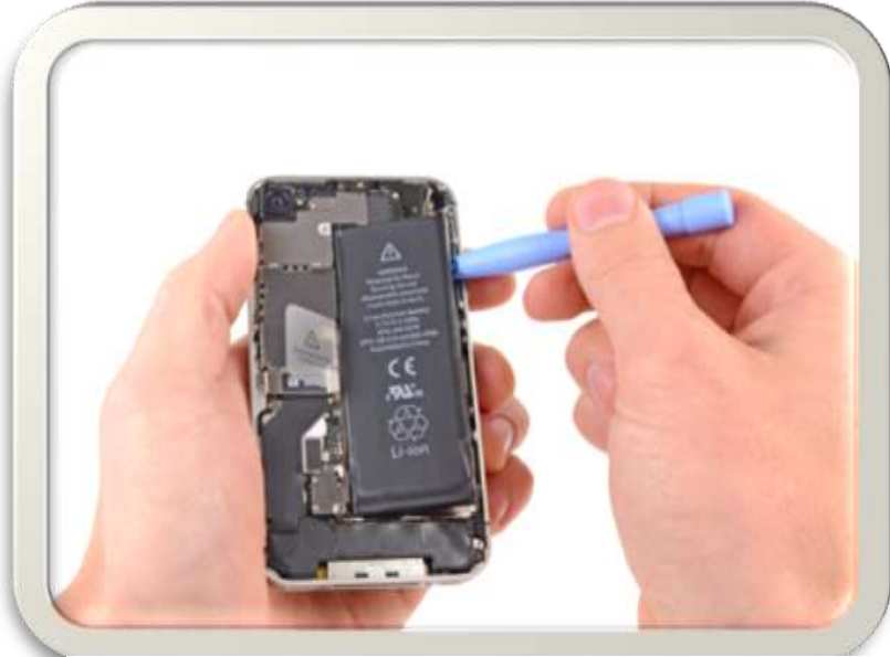
خطوة (9): إدراج أداة البلاستيك بين البطارية والحافة الخارجية
