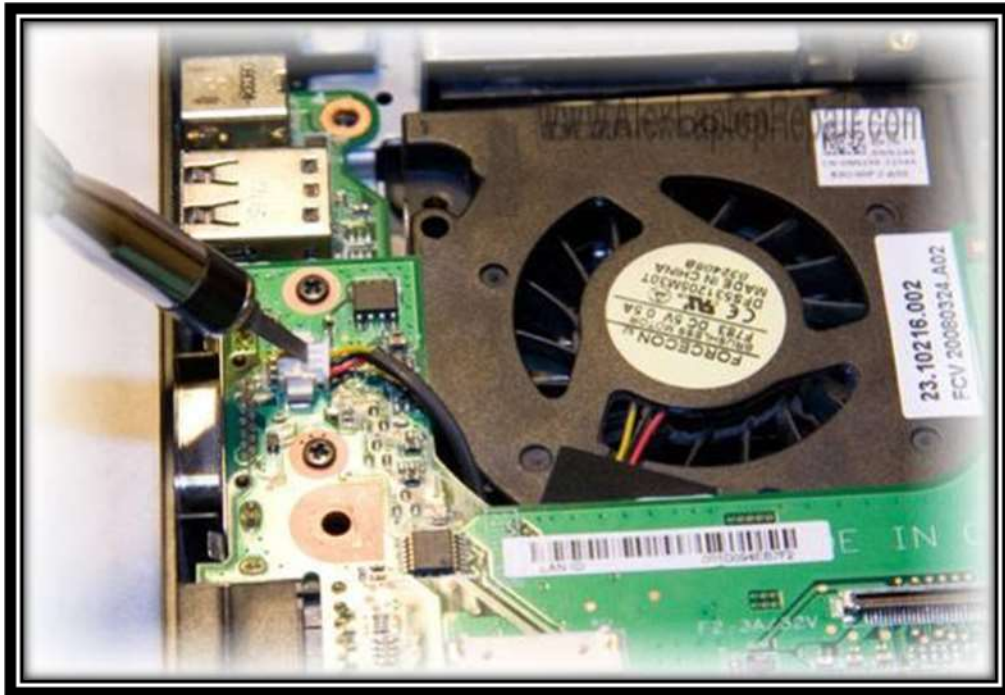
شكل(53): تحريك الكيبل الخاص بمروحة تبريد الجهاز
