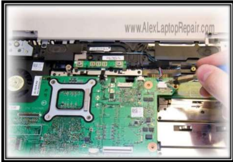
شكل(32):رفع الكيبل الخاص بالسماعات
