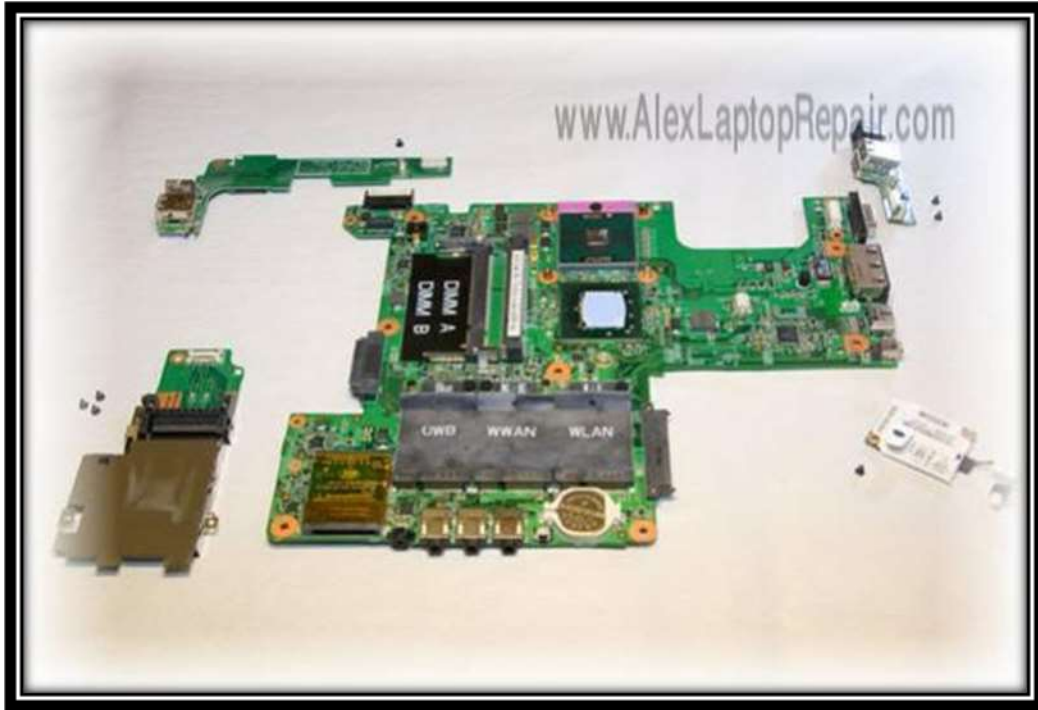
شكل (62): الأجزاء التي تم فصلها عن المادِر بورِد
