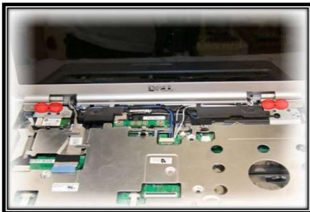
شكل (16): فك البراغي الخاصة بالمفصلات 17- القيام برفع كيبيل الوايرليس الذي تم فكها من اسفل الجهاز، الشكل (17).
