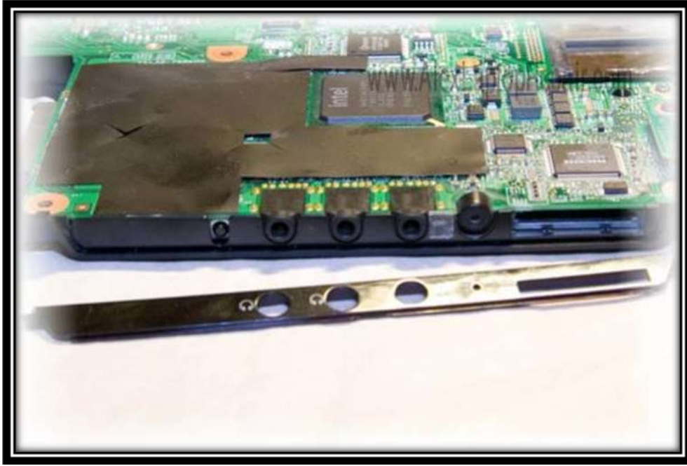
شكل (31): صورة أخرى للغطاء الموجود في الجزء الامامي من الجهاز
