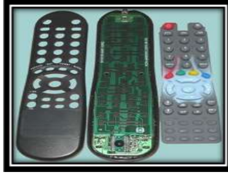
شكل ( 8 ) : فك اجزاء الريموت كنترول
