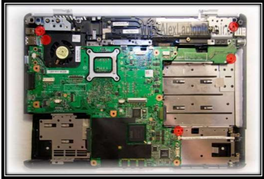
شكل(52): القيام بفك البراغي الموضحة بالصورة
