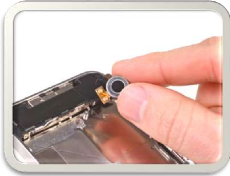
خطوة(36): ازالة الرجاج - Vibrator - باليد
