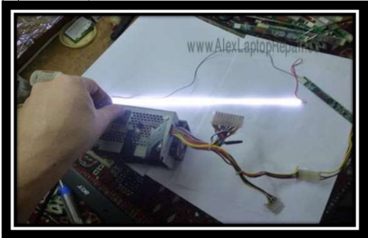
شكل(85): توصيل مصدر الطاقة مع الانفيرتر
