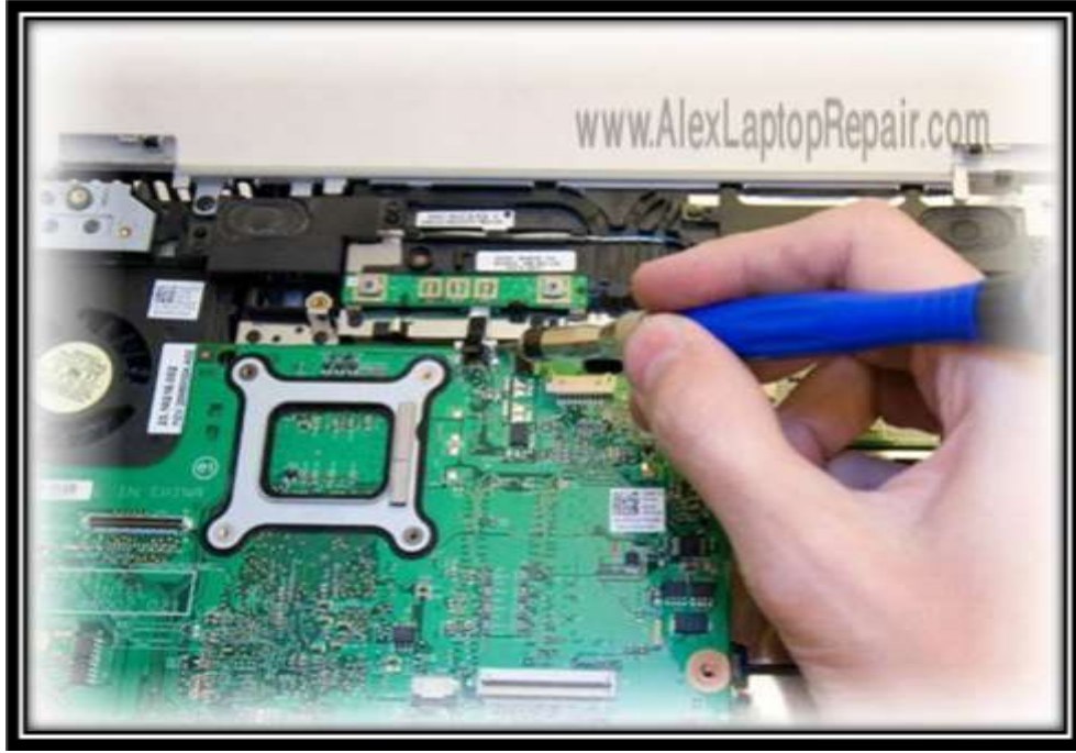
شكل(33): برفع الفلاته الخاصه بالجزء المثبت عليه مفتاح الباور
