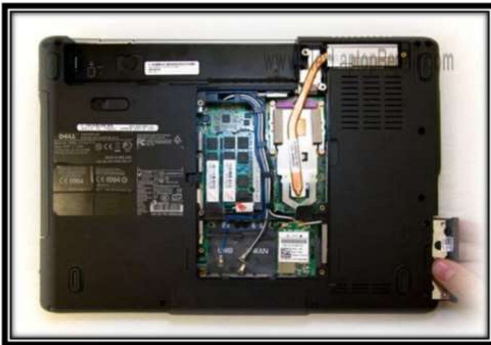
شكل (3): باخراج الهارديسك من الجهاز
