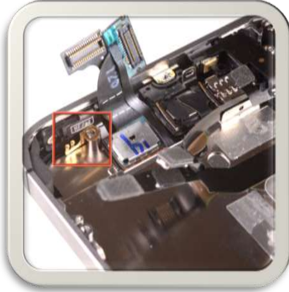
خطوة(34):اخراج القطعة الموجودة بجوار كبسة البور
