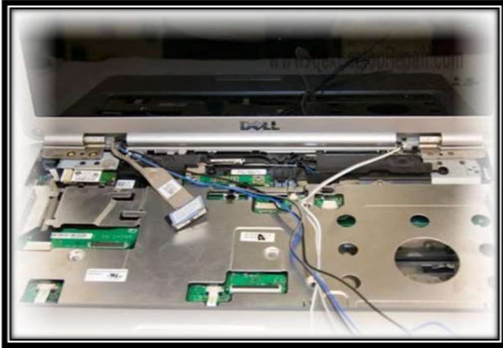
شكل (18): رفع الفلاته الخاصه بشاشة الجهاز 19- فصل شاشة الجهاز ، الشكل(19) ويجب وضعها فى مكان امن لحين الاحتياج لها.
