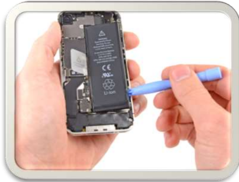
خطوة (8): إدراج أداة البلاستيك بين البطارية والحافة الخارجية
