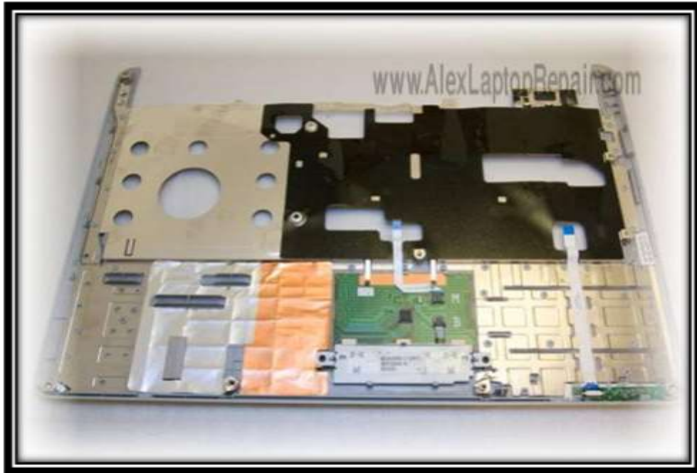
شكل (26): رفع الجزء العلوي للجهاز
