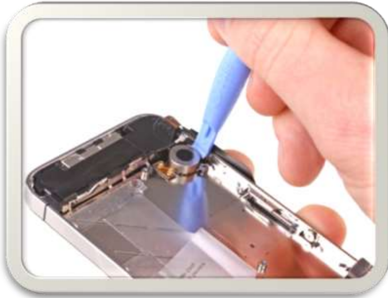
خطوة(35):البدء بإزالة الرجاج باستخدام الأداة البلاستيكية
