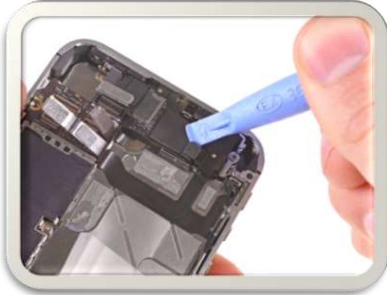
خطوة (30): فصل انتين - Wi-Fi antenna
