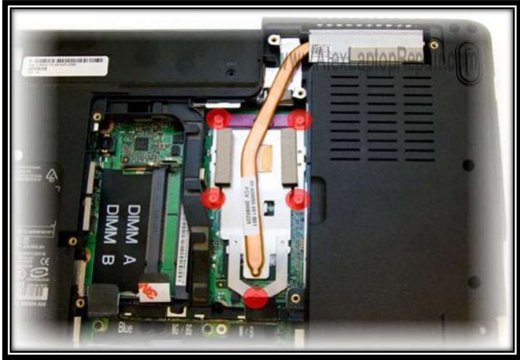
شكل(46): فك جميع البراغي المثبت بها الهيئ سينك
